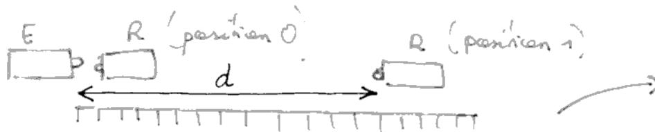
→ Pour les mesures on fixe l'émetteur et on déplace le récepteur puis on note d les observations !  $d \neq \Delta t$
