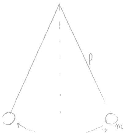
Tout d'abord, on doit mesurer la durée d'une dizaine d'oscillation afin d'éviter les erreurs expérimentales.  $\Delta t = nT$
