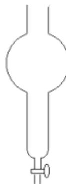
Ampoule à décanter
